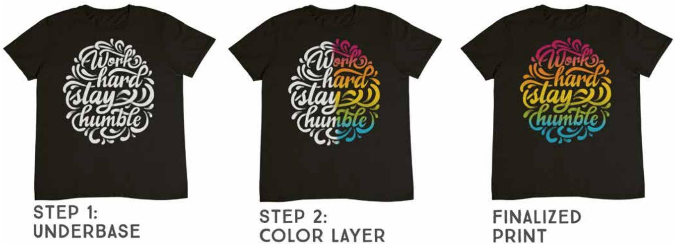
Auf farbigen und schwarzen Textilien wird mit weißer Tinte zunächst ein weißer Untergrund gedruckt, bevor darauf im Anschluss der Farblayer gedruckt wird.
